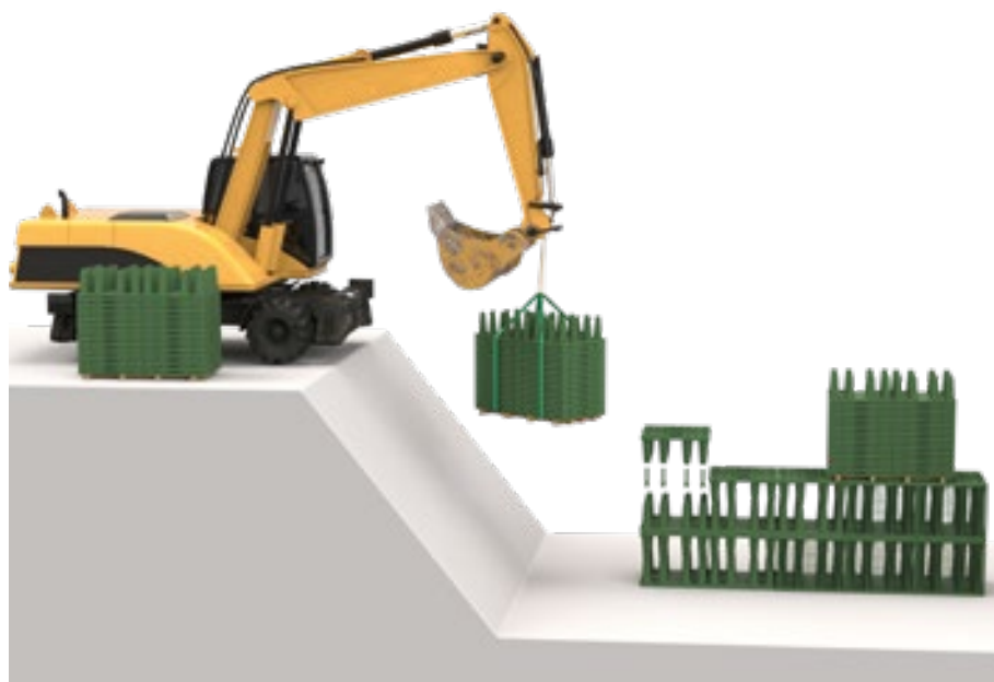
Montaż w wykopie budowlanym
